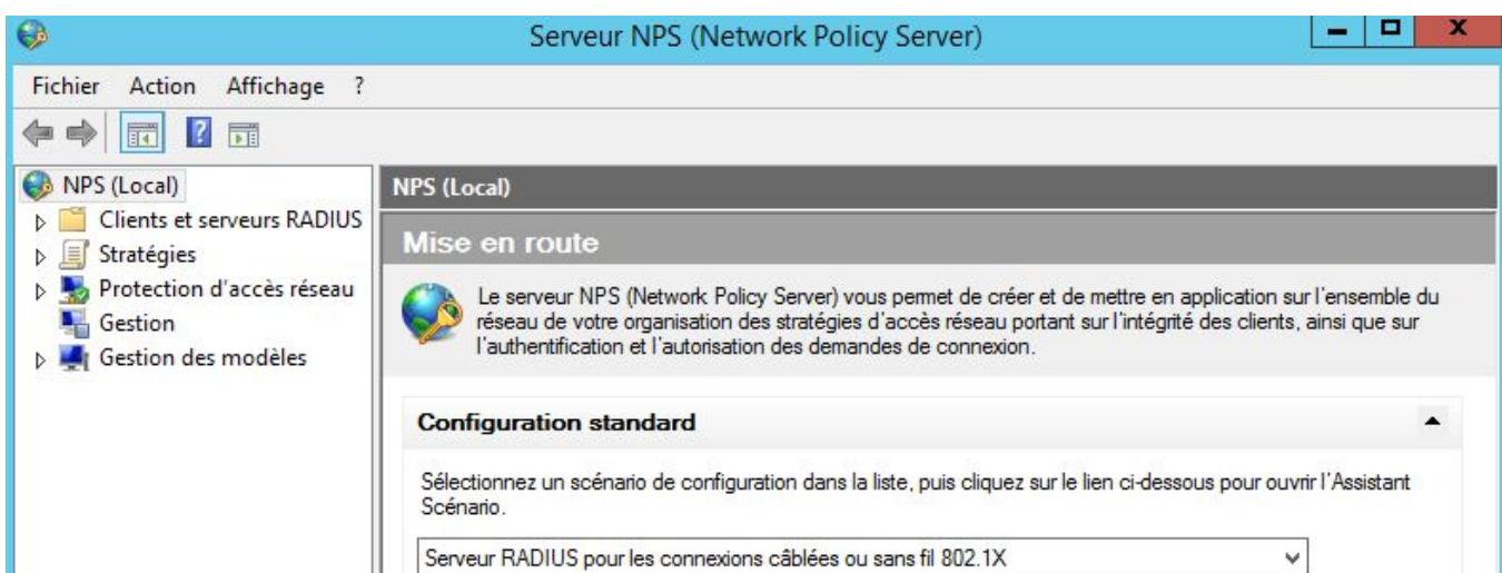
Une fois ce serveur installé, comme on peut le voir sur le côté gauche, il fallait créer un client Radius. Ce client représentera donc le point d'accès.
