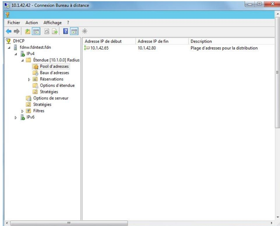
Après l'avoir installé, j'ai ainsi créer une étendue réservée au serveur Radius, ainsi, chaque appareil qui se connectera au point d'accès recevra une adresse ip entre "10.1.42.65" et "10.1.42.80".
